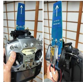
別の方法としては、指向性八木アンテナは着脱可能なので、通常は市販の無指向性アンテナを使用し、搜索時は指向性八木アンテナに付け替える方法もあります。
